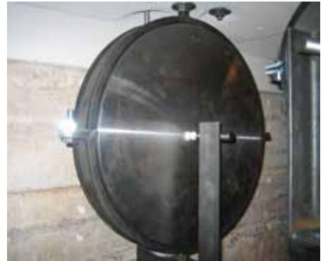
Rohrschelle vor dem Brandversuch mit Prüf-Dummy zur Gewichtssimulation
