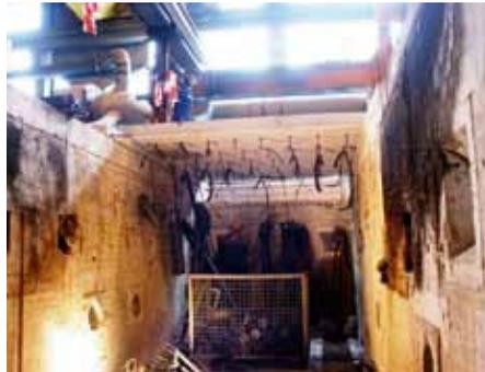
**Der Brandofen nach dem Test: Alle Rohrschellen wurden bis zur Zerstörung geprüft. Das Ergebnis wird ausgewertet und die zulässigen Lasten ermittelt.**
