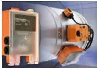
Mit den Kommunikations- und Netzgeräten „BKN230-24-MOD“ (24 V) und „BKN230-MOD“ (230 V) von Belimo wird der Antrieb der motorisierten Brandschutzklappe direkt über Modbus RTU an die zentrale Steuerung angeschlossen. Damit können die Klappenposition sowie der Zustand des optionalen Rauchmelders und der thermoelektrischen Auslöseeinrichtung ebenso signalisiert werden
