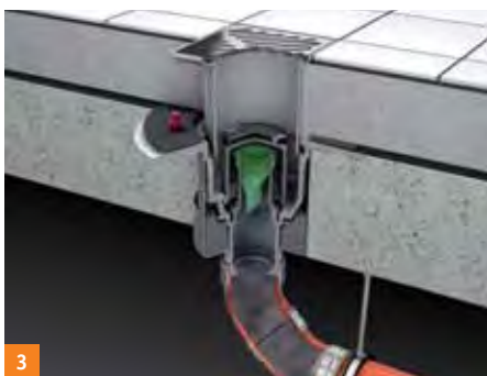
ACQ Bodenablauf Passavant nach Verschluss des oberen Brandschotts (1) und ACQ Bodenablauf Passavant mit aktivierter Brandschutz-Kartusche gegen Feuer von unten (2). Der optionale Geruch- und Rauchstopp verhindert das Ausbreiten von Rauch und das Eindringen von Gerüchen aus der Kanalisation bei fehlender Wasservorlage (3).
