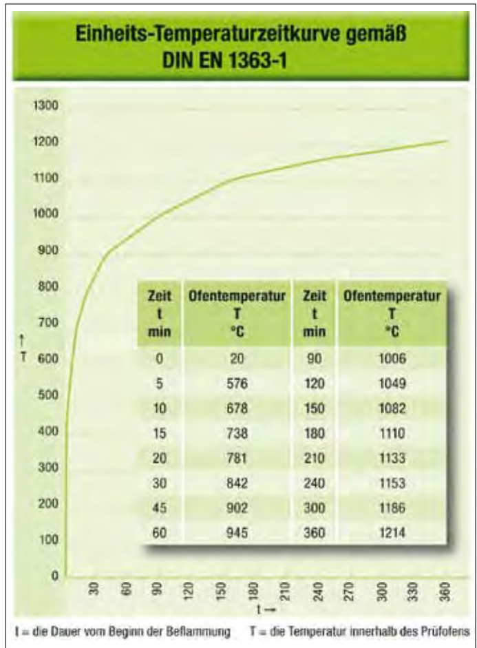
Abbildung 3: Einheits-Temperaturzeitkurve gemäß EN 1363-1
