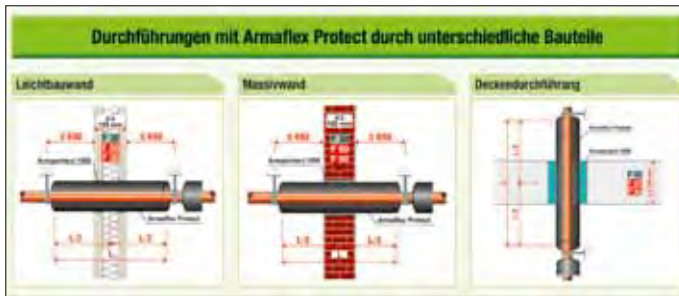
Abbildung 6: Durchführungen mit „Armaflex Protect“ durch unterschiedliche Bauteile
