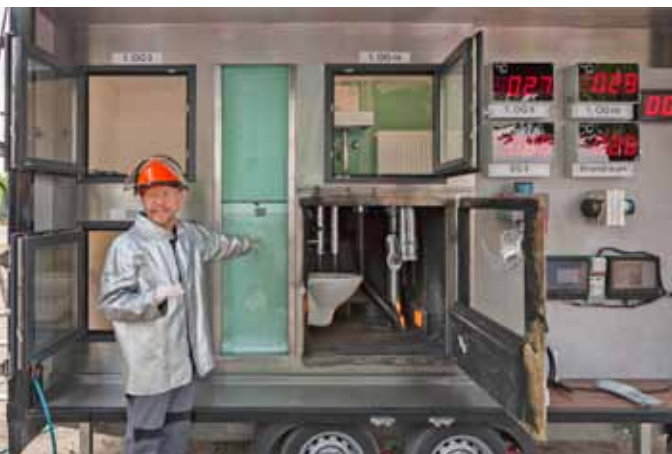
Brandschutzexperte Bernd Prümer beim Live-Brandversuch am Geberit-Brandschutzcontainer
