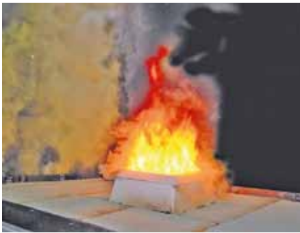
DIN 18234-3 Prüfung mit PIR-Dämmung an der Universität Karlsruhe
