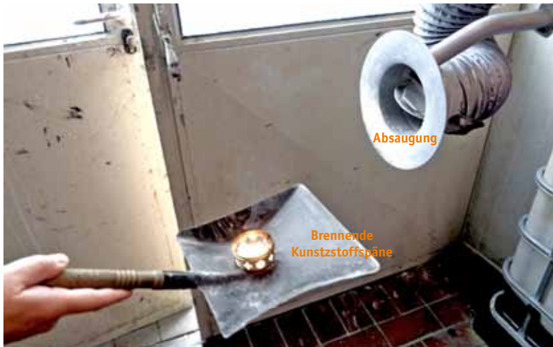
Erfolgreicher Versuch in der Galvanik: Schon kleinste Rauchmengen konnten detektiert werden.
