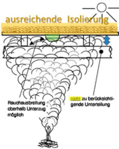
Wie bisher, keine Berücksichtigung wenn Abstand > 0,25 m → wie flache Decke projektieren
