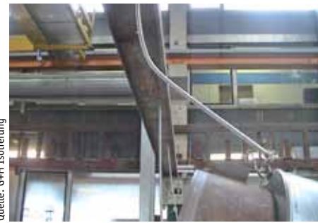
Brandversuch vom 4. Juli 2012: Die Abhängungen auf der Luftseite sind stark verbogen.
