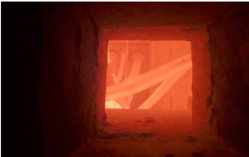
Brandversuch vom 11. April 2012: Hier sieht man die Durchbiegungen der Rohre auf der Feuerseite.
