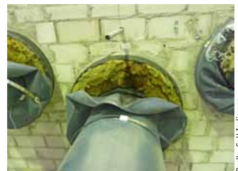
Nach dem Brandversuch vom 11. April 2012: Die Mineralwollestopfung weist keine Sinterungserscheinungen auf!
