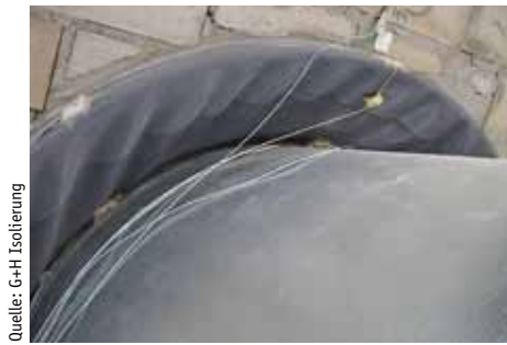
Brandversuch vom 11. April 2012: Das Rohr zieht sich in den Brandraum hinein.
