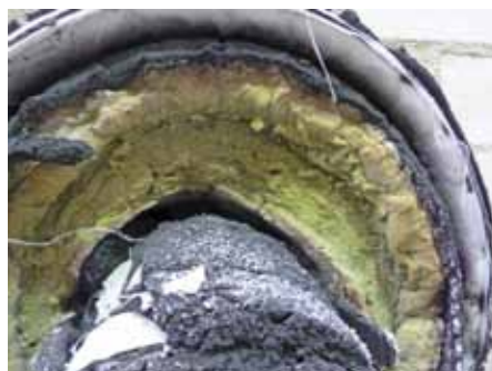
Nach dem Brandversuch vom 11. April 2012: Ansicht Feuerseite: alles verschlossen!
