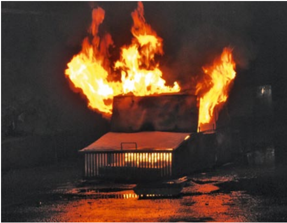
Die Flammen schlagen aus dem Auto-Dummy, der mit Schaumstoff und 4l Benzin präpariert ist.
