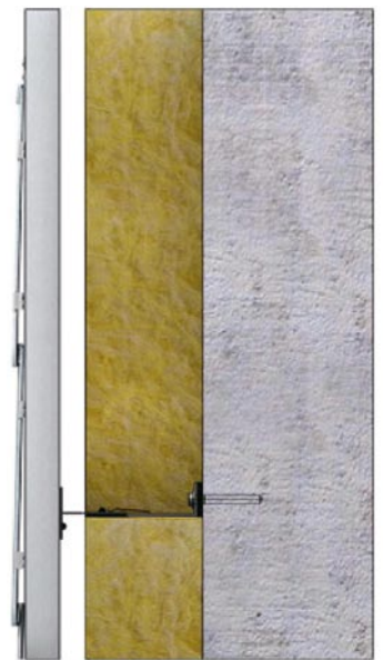
Klassischer Aufbau einer Rheinzink-Fassade auf Metallunterkonstruktion.
