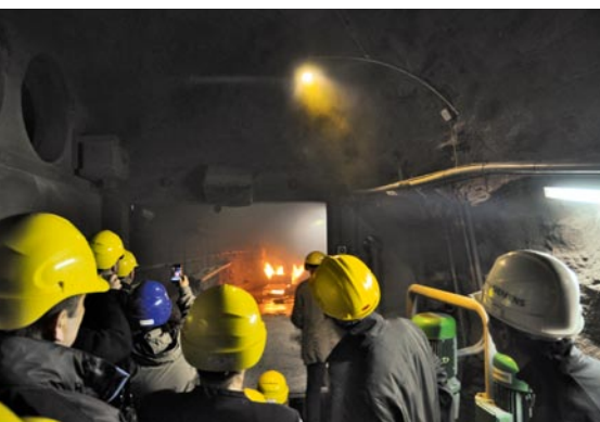
Die Teilnehmer des Brandversuchs zeigen sich beeindruckt; bei starker Rauchentwicklung ist der hellgrüne Lichtstrahl (re.) nicht mehr vom menschlichen Auge wahrzunehmen, was ein anschauliches Beispiel für die Hürde der Evakuierung aus einem verrauchten Tunnel ist.
