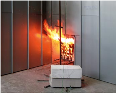
Brandprüfung mit rund 800 °C am Fenstersturz.
