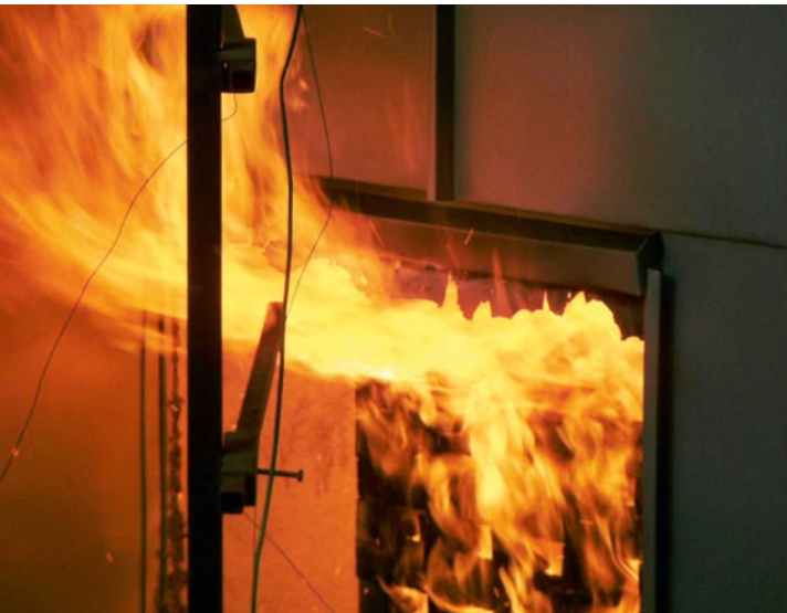
Ohne Beanstandung: Brandprüfung an vorgehängter hinterlüfteter Fassade.
