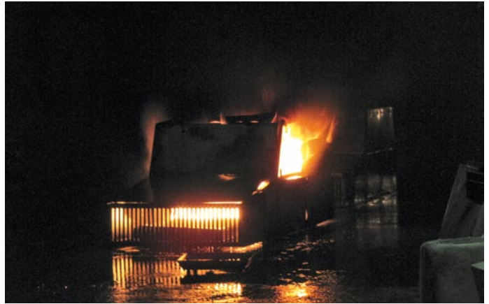
Das automatisch ausgelöste Löschintervall schafft Zeit, um sich aus dem Tunnel zu retten bzw. als Rettungskräfte an den Brandherd heranzukommen.
