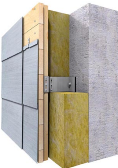
Klassischer Aufbau einer Rheinzink-Fassade auf Vollholzschalung.
