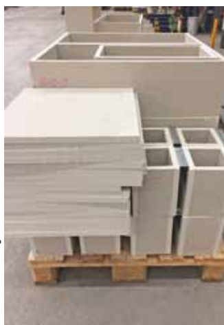
A) Je Gebäudeabschnitt werden standardisierte Verkleidungen zusammengefasst
