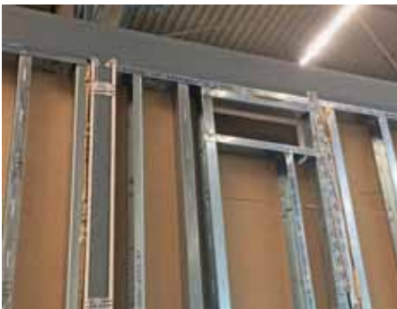
In der Abteilung Wand-Fertigung, werden die bezeichneten Durchbrüche entsprechend der Anforderung produziert und für den späteren Ausbau auf der Baustelle vorbereitet.
