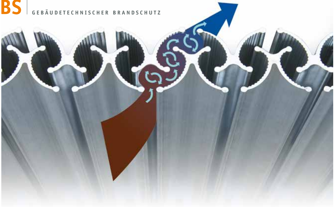
Prinzip der X-Cyclonabscheidung
