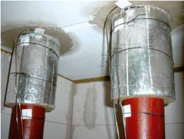
Gusseiserne Abflussrohre beim orientierenden Brandversuch bei der DMT in Dortmund – „Brandsicherheit auch von oben nach unten“
