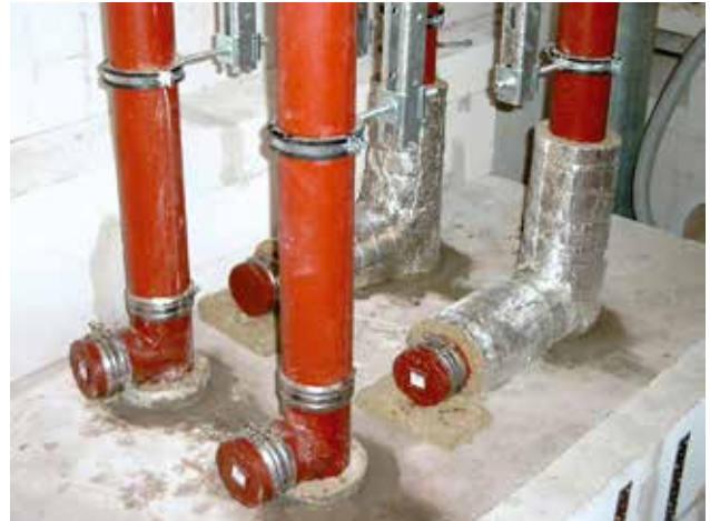
Gusseiserne Abflussrohre beim orientierenden Brandversuch bei der DMT in Dortmund – „Brandsicherheit auch von oben nach unten“
