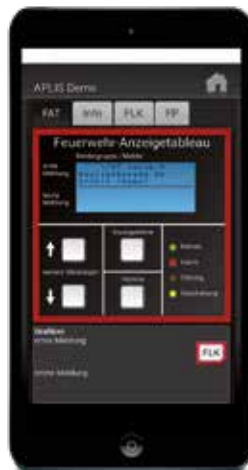
Mit dem grafischen Informationssystem "Aplimo/Aplis" lassen sich Brandschutzgrafiken digital speichern und ausdrucken sowie zusammen mit Echtzeit-Informationen der angeschlossenen Brandmelderzentralen auf mobilen Endgeräten anzeigen.
