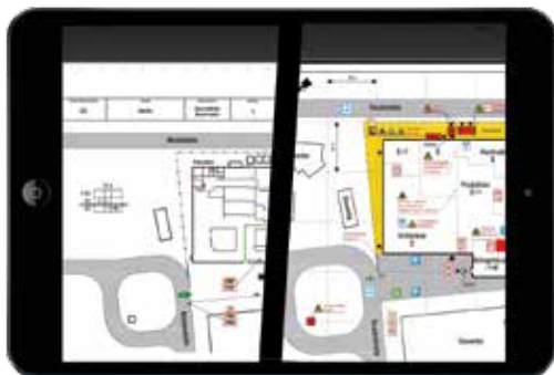
Mit dem grafischen Informationssystem "Aplimo/Aplis" lassen sich Brandschutzgrafiken digital speichern und ausdrucken sowie zusammen mit Echtzeit-Informationen der angeschlossenen Brandmelderzentralen auf mobilen Endgeräten anzeigen.
